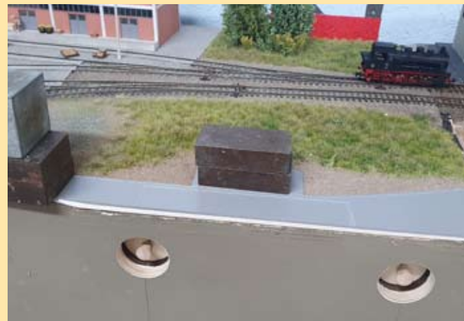
Auch hier wurden die Randsteine und auch die Lkw-Waage in das weiche PVC eingraviert und das Ganze zur besseren Nivelierung mit Eisenklötzen beschwert.
