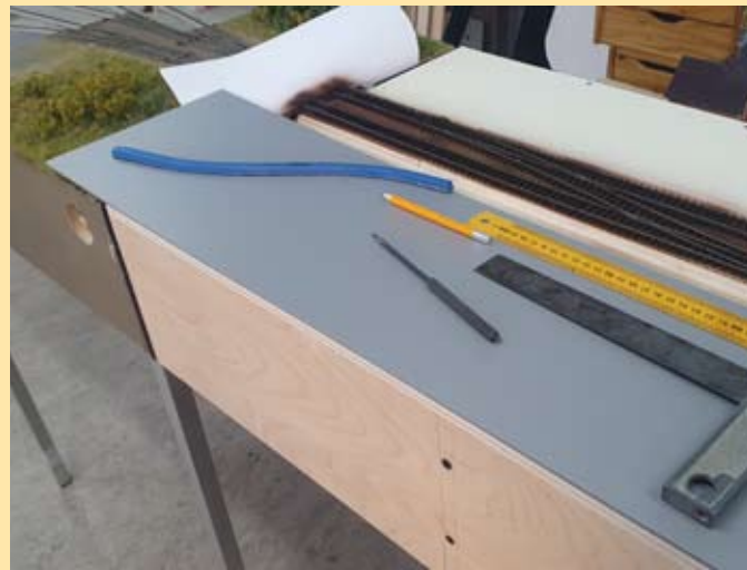
Auf dem Erweiterungsmodul entsteht die Fahr- und Parkfläche aus dem bekannten, grauen PVC-Belag. Die Verläufe lassen sich mit Lineal und biegsamem Kurvenlineal genau wunschgemäß zurechtschneiden.
