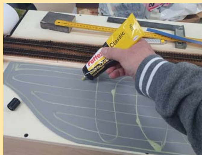
Die Verklebung der Platte mit dem Holzuntergrund erfolgt am sichersten mittels eines lösungsmittelhaltigen Kontaktklebers, der nach beidseitigem Auftrag und Antrocknen gut angedrückt wird.
